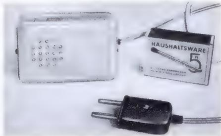
Bild 1. Das magnetische Transistormikrofon ist wenig größer als eine Streichholzschatz
