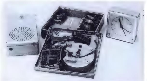
Transistor-Kleinempfänger mit Kurz-, Mittel- und Langwellen (links), ansetzbarer Batterie-Plattenspieler für 45er-Platten (mitte) und Schaltuhr, so daß man sich morgens mit Schallplattenmusik wecken lassen kann (Max Braun)
