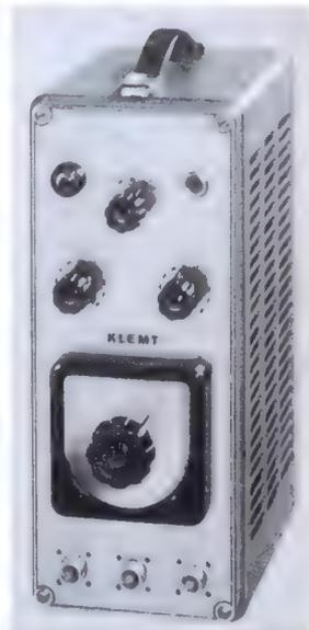
Bild 6. Der Klemt-UHF-Wobbler für die Service-Werkstatt. Ein weiterer UHF-Wobbler ist in Einschubform gebaut und für die Zusammenstellung von Prüfplätzen in Prüffeldern bestimmt
