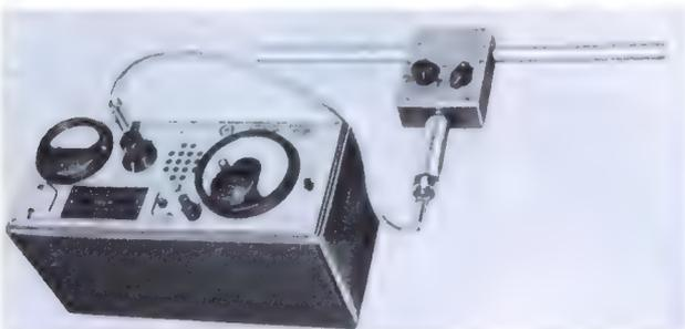
Bild 7. Tragbares und batteriegespeistes Siemens-Transistor-Betriebsstörmeßgerät 150...3000 kHz
